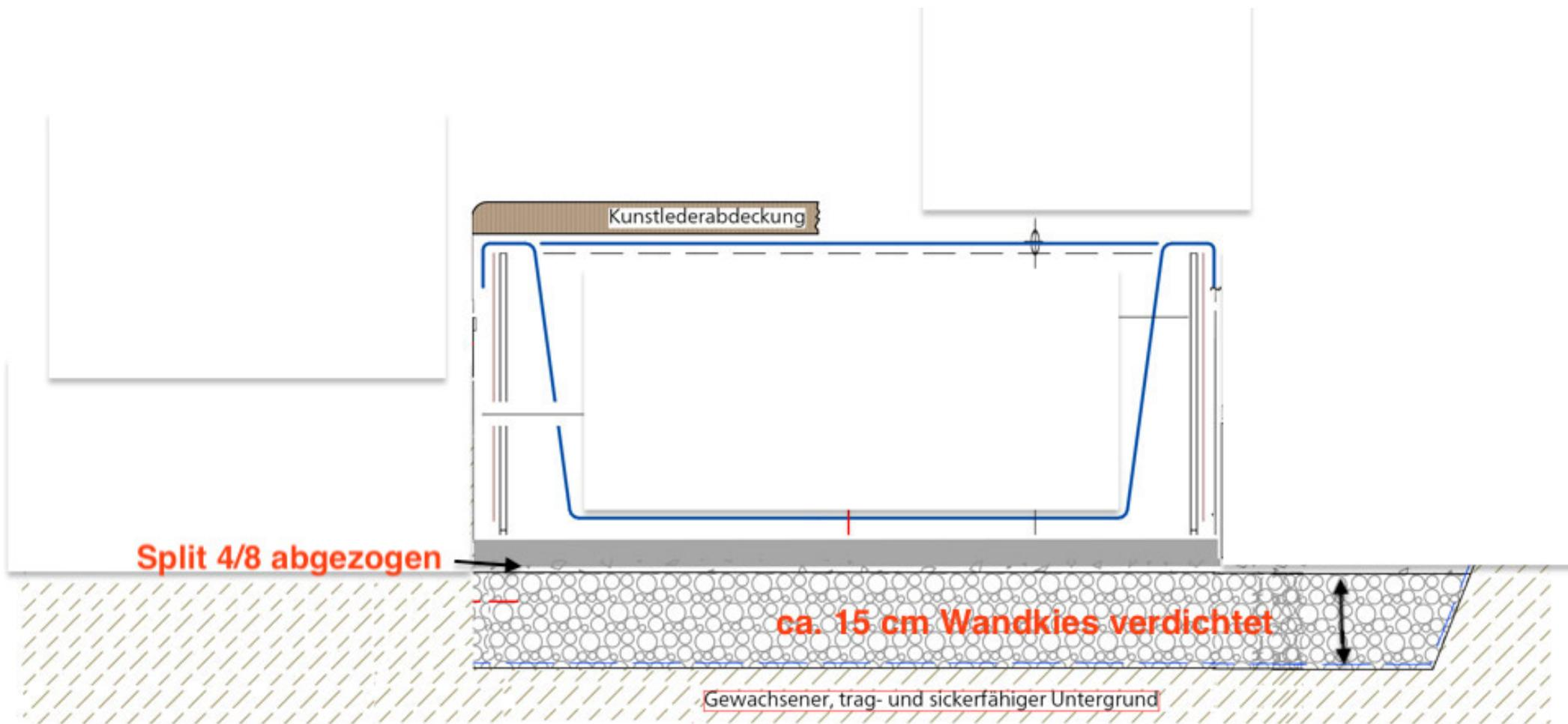
**Schichtaufbau auf gewachsenem Boden: ca 15-20cm Wandkies mit Plattenvibrator verdichtet. Darauf ca. 5cm Split 4/8mm eben abgezogen. Darauf kann dann der Whirlpool direkt drauf gestellt werden.**
